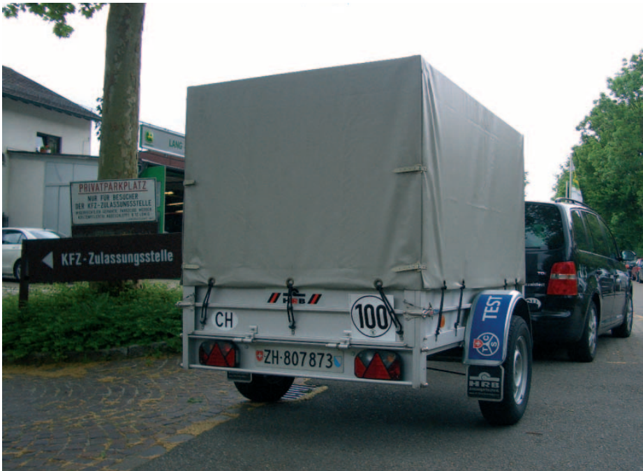
Im Mai 2008 organisierte der TCS mit einem Dienstwagen als Zugfahrzeug erstmals eine Tempo-100-Plakette in Deutschland. Der Transportanhänger wurde von Heinemann zur Verfügung gestellt. Vor dem Test baute der Importeur am Hänger die notwendigen Stossdämpfer ein. Das Schweizer Gespann durfte nach der Abnahme mit Tempo 100 gefahren werden. In der Schweiz muss die Plakette 100 abgedeckt werden.
